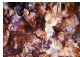
写真 2 不攪乱まさ土試料の断面拡大画像
