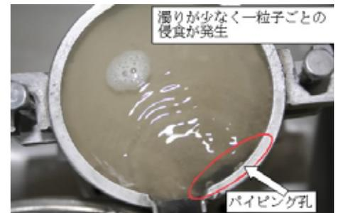
図4 500秒後の clay60%供試体上部の様子
