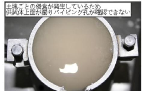
図3 200秒後の clay60%供試体上部の様子
