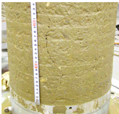
写真4 クラックの発生状況例 ( D_{max}=19mm 、左:外側、右:内側) ( D_{max}=19mm 、 \sigma_3=392kN/m^2 )
