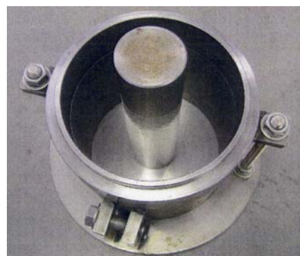
写真 1 供試体作製モールドとロッドの例 (ロッドの直径が 5cm の場合)
