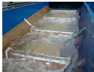
写真 1 2 分の 1 縮尺模型 ( i=1/10, m=1, S=9\text{cm}, h=18\text{cm} Q=0.0315\text{m}^3/\text{s}, dc/s = 0.49 )
