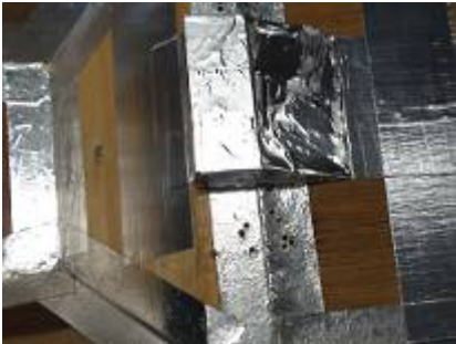
写真2 突起物を設置した台形断面魚道模型
