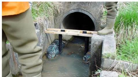
図-2 水路に設置したPitタグ読み取りアンテナ
