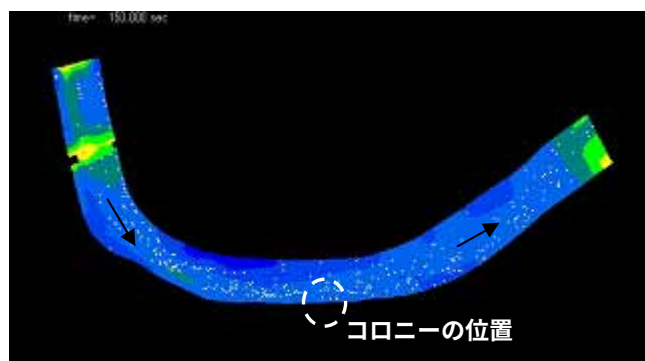
図 2 平面 2 次元流れ解析コンター図
