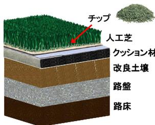
図-1 人工芝グラウンドの模式断面図
