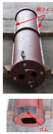
写真3 内管全景(上)と緩衝ゴム(下)
