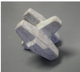
図-2 合掌ブロックの模型（長さの縮尺: 1/43）
