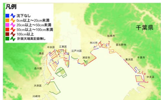
沈下量(計画天端高-現況天端高)
