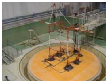
写真-1 コンテナクレーン模型設置状況
