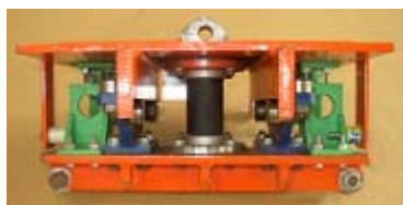
写真-2 実験に使用した脚部免振装置
