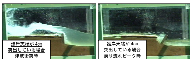
写真-1 戻り流れに対する護岸の安定性検討実験結果
