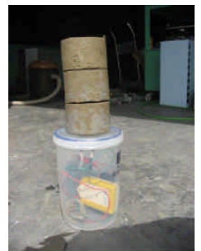
図6 設置した洗掘深センサー
