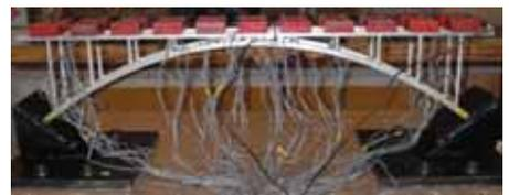
図-2 実験供試体(case0,おもり載荷状態)
