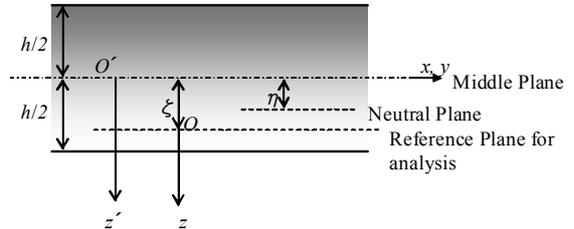
図-1 不均質長方形板における板厚方向の座標系
