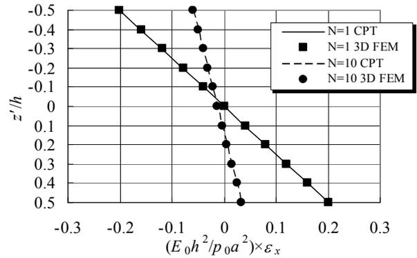
図-2 ひずみ  $\epsilon_x$  の板厚方向分布 :  $h/a = 0.1, b/a = 1$
