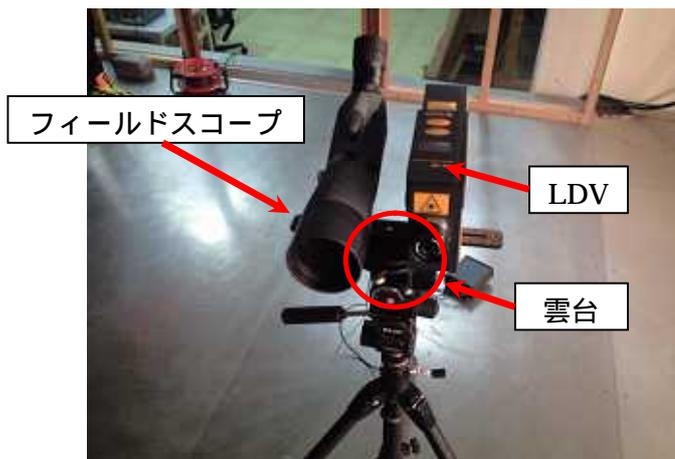
図 1 LDV 長距離振動計測システム
