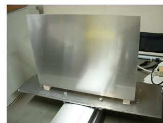
Photo 1 実験模型と加振用スライダー
