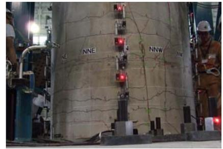
図-4 100%加振2回目終了後の損傷（降伏状態）
