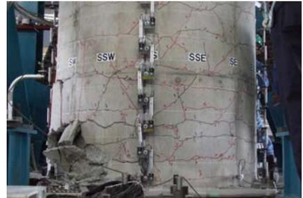
図-5 100%加振3回目終了後の損傷（終局状態）
