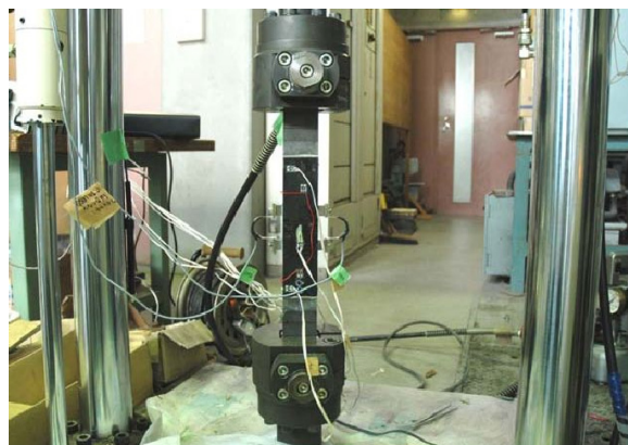
写真-1 疲労試験状況
