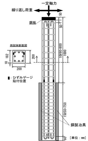
図-1 供試体図 (一例)
