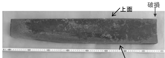
写真-2 フィンガー破損品
