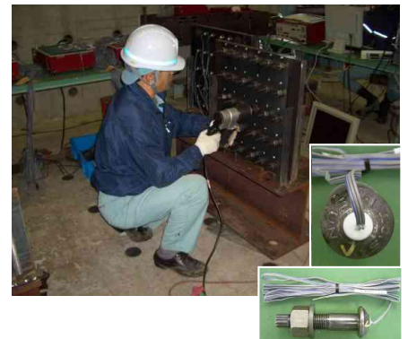
図-3 試験状況（TYPE-C ボルト締付け）
