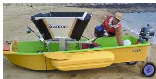
図3 ボートに載せた観測装置全体写真
