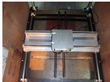
図-2 模型支持装置
