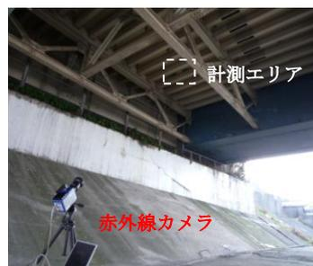
図1 赤外線計測状態
