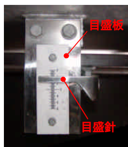
写真-2 たわみ計測装置
