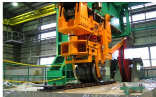
写真-3 輪荷重走行試験機
