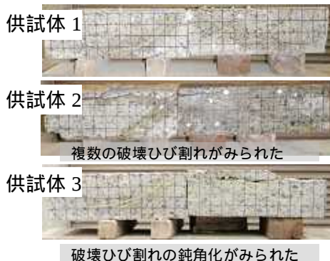
写真-1 押抜きせん断実験の破壊状況(専用供試体)
