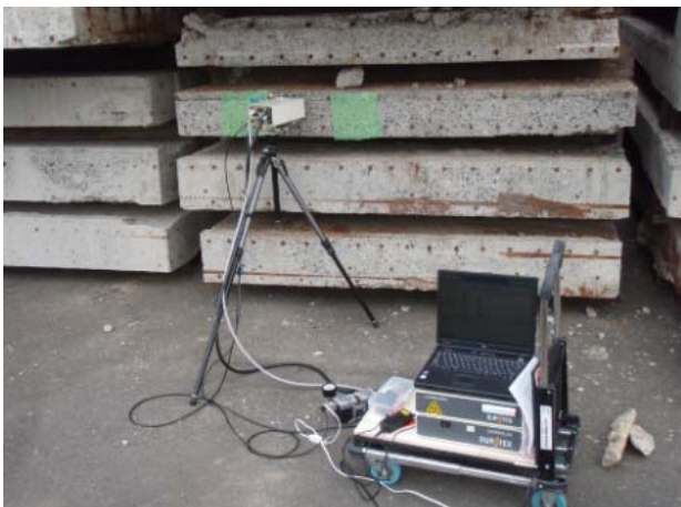
写真3 蛍光X線照射法の調査状況
