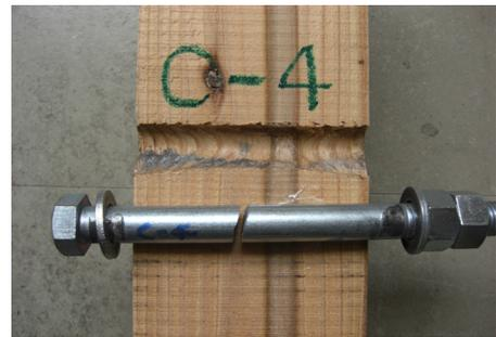
写真-2 破断したボルトとめり込みが生じた木材
