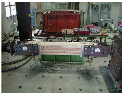
写真-1 既往の繰り返し載荷試験の様子
