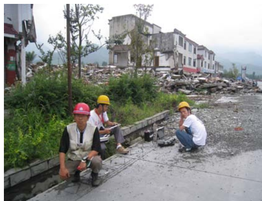
図4 彭州市小魚洞鎮の断層直上での微動観測
