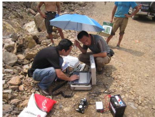
図3 青川県青竹河・紅光河地滑り地点での常時微動観測(EL680m)
