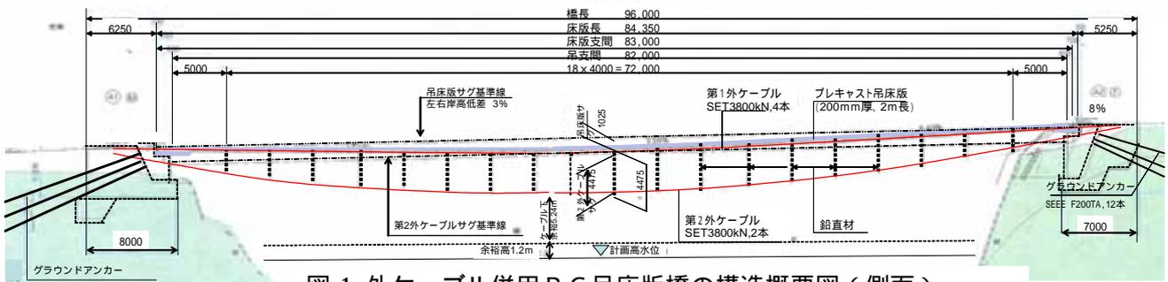
図-1 外ケーブル併用PC吊床版橋の構造概要図(側面)
