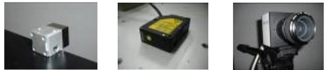
a) 加速度計 b) 変位計 c) ハイスピードビデオ
