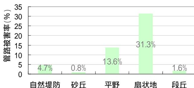
図3 微地形と下水道管被害率の関係(柏崎市)
