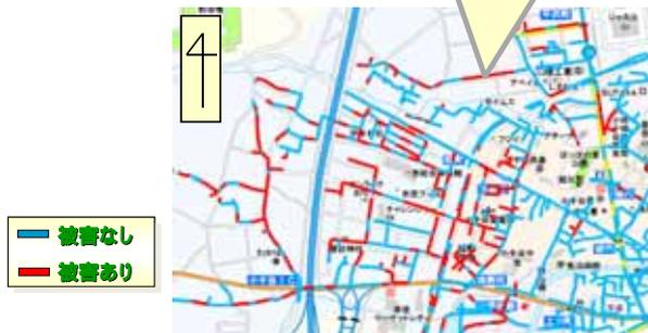
図1 下水道管路と被害データベース(小千谷市)
