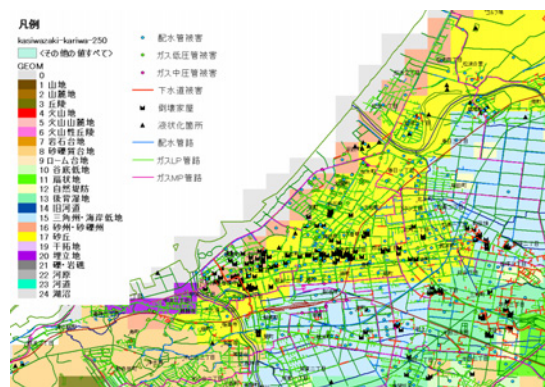
図-2 柏崎市における微地形区分と埋設管被害分布
