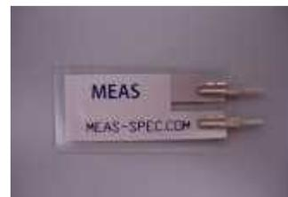
写真 1 piezoelectric sensor
