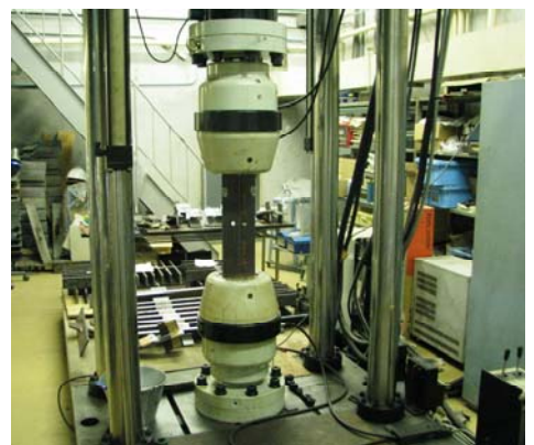
写真 2 疲労試験状況
