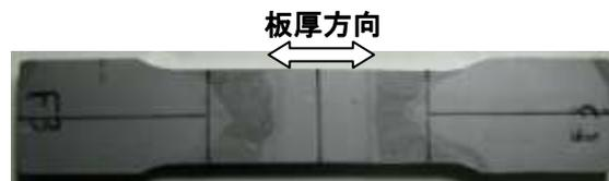
写真2 引張試験片の形状 (JIS7号試験片)
