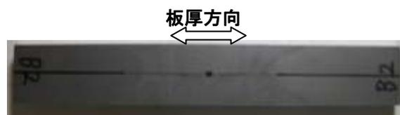
写真3 疲労試験片の形状
