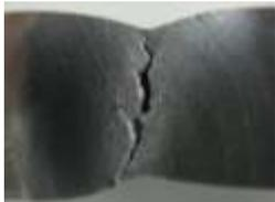
写真4 引張試験結果:破断状況(現代の鋼材)
