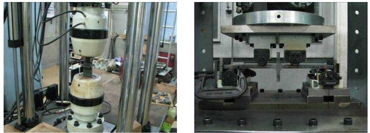
写真1 軸力疲労試験と板曲げ疲労試験
