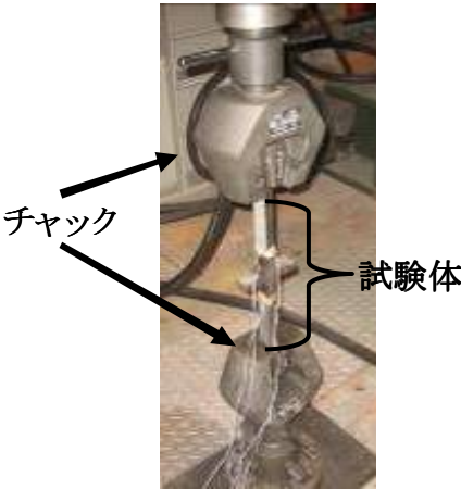
図-2 疲労試験実施状況
