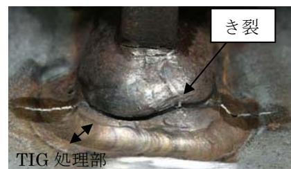
図-4 処理部以外から発生したき裂の様子
