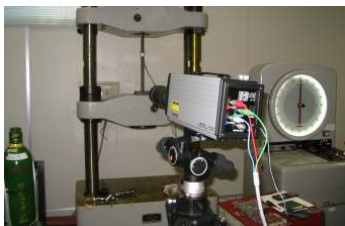
図7 PC 鋼より線の固有振動計測
