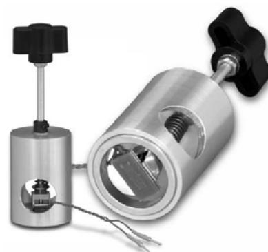
図-2 従来型応力聴診器
