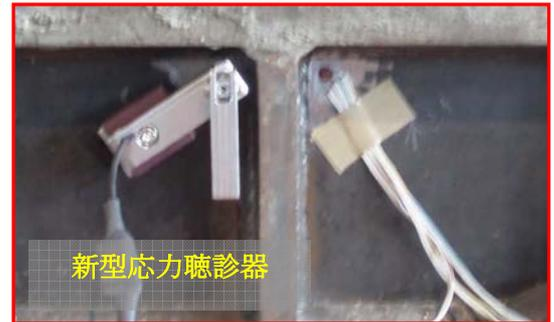
図-7 新型応力聴診器設置状況
