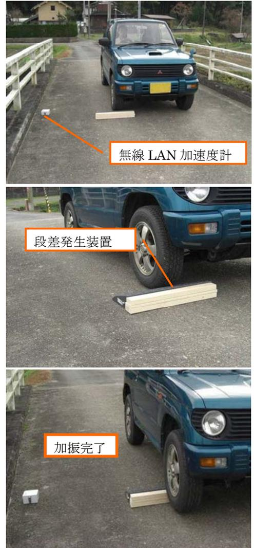
写真-1 固有振動数の計測
