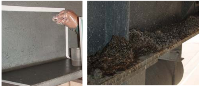
写真-2 付着塩分の測定状況
