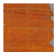
試験片 B 150℃まで加熱後に急冷
