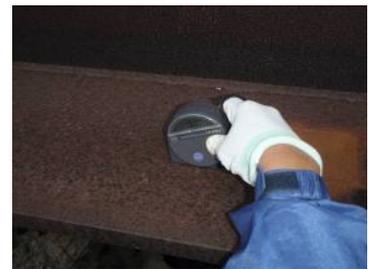
写真2 さび厚測定状況
